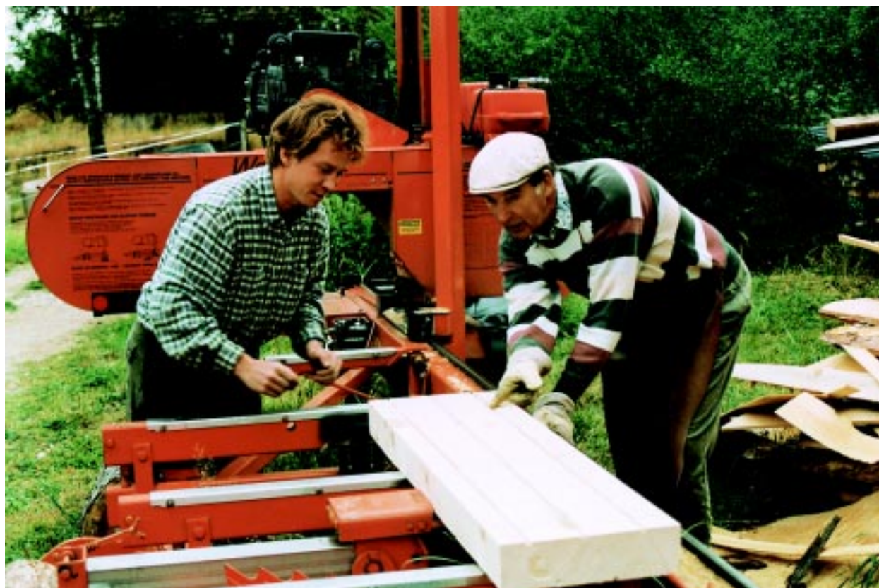
Kjell Wiklund och jag delar ett block limmat av trekanter vid den pilotanläggning för PrimWood Prisma som uppförts på Åke Lundqvists gård Heda utanför Södertälje. Bakom kameran Åke själv.
