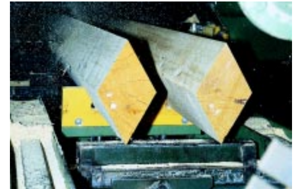
Stjärnsågning enligt den metod som användes i pilotanläggningen i Arjeplog.
