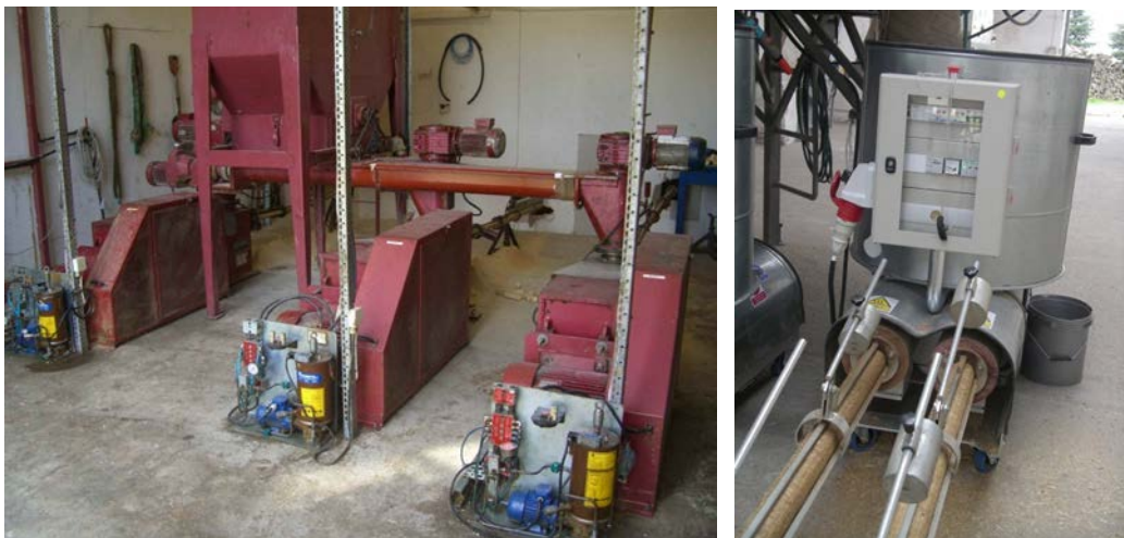
Figur 2. Kolvpressteknik och skruppressteknik för brikettering av rörflen.
