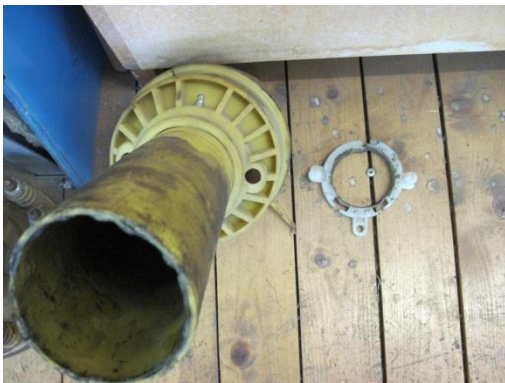
Figur 16. Låsningen på skyddet är bortplockat.
