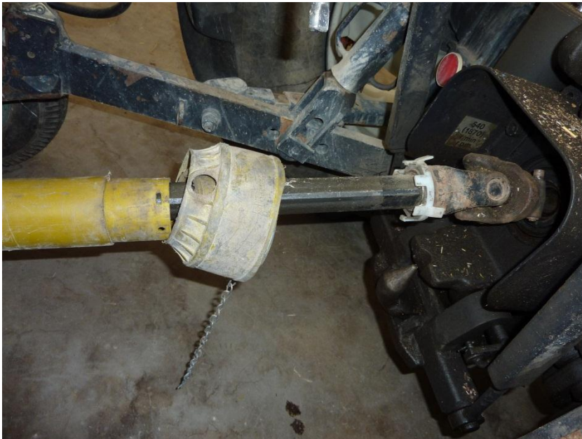
Figur 1. En farlig kraftöverföringsaxel.
