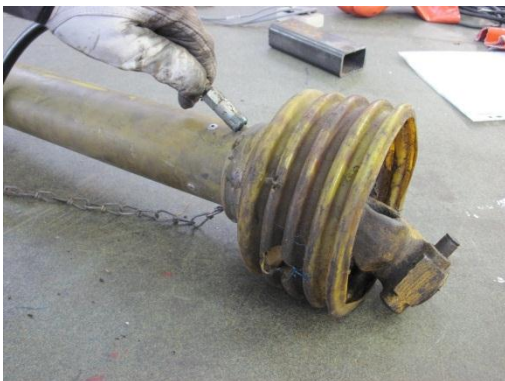
Figur 9. Nippeln till glidlagret är i detta fall av plast.
