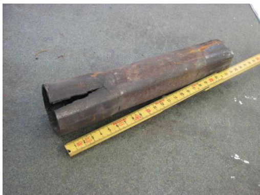
Figur 14. Brott på den yttre delen av kraftöverföringsaxeln.
