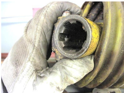
Figur 13. Spärren på kraftöverföringsaxeln.
