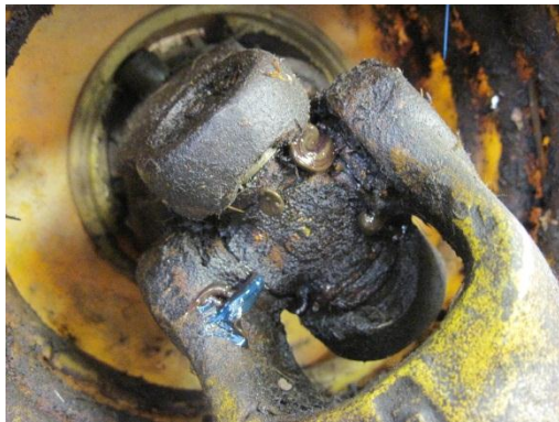
Figur 8. Smörjfettet ska fylla utrymmet i korset, så de små kullagren smörjs ordentligt.
