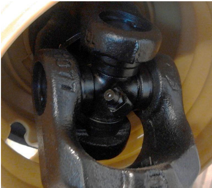
Figur 3. Foto på ett kors med en smörjnippel i mitten.
