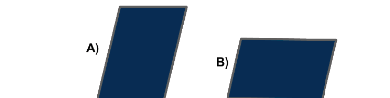
Figur 11. Visar skillnaden mellan A) stående modul och B) liggande modul.
