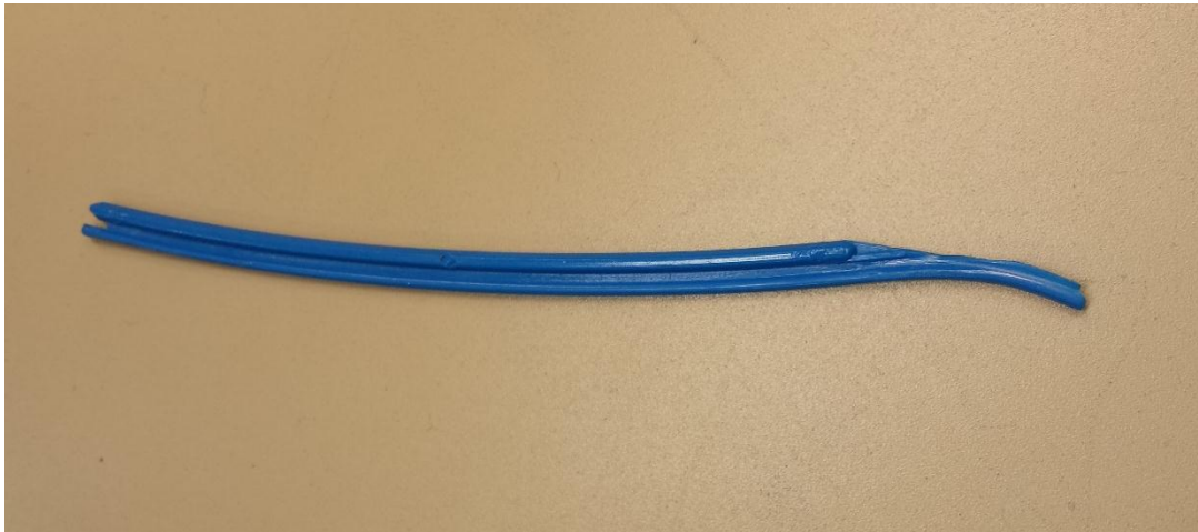
Figur 6. Bilden visar verktyg för kabelmärkning.
