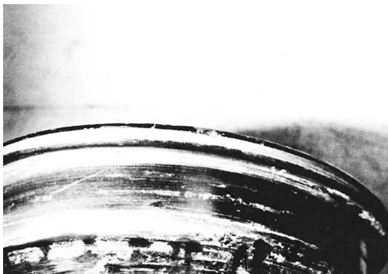
Figur 18 Gummiavlagring från däckfoten, ett tecken på för lågt lufttryck. Från Grogan (1999).
