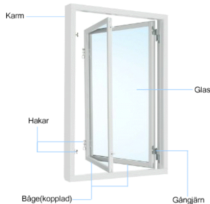
Figur 17:Fönsterkonstruktion[44].
