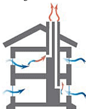
Figur 2: Illustration av självdragssystem[8].
