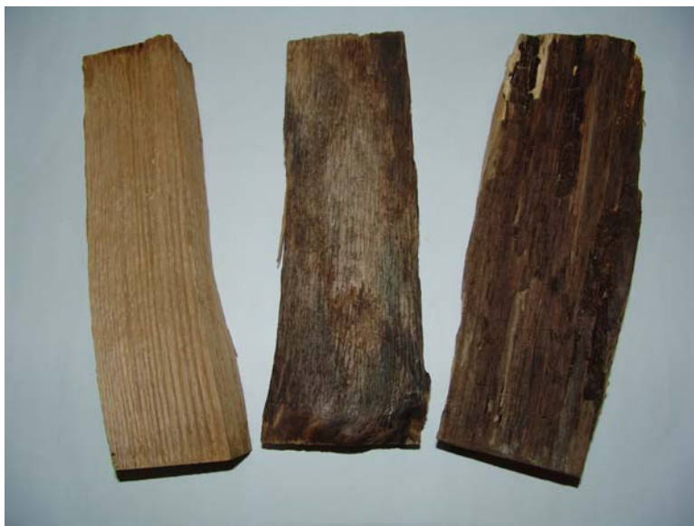
Figur 1. Undersökta vedkvaliteter av alm; frisk ved (vänster), något rötskadad ved (mitten) och rötskadad ved (höger).
