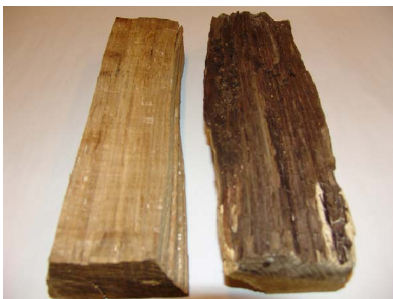
Figur 3. Torrdensiteten hos något rötskadad ved av ek (vänster) låg på 633 kg/m 3 f, medan torrdensiteten endast var 530 kg/m 3 f hos rötskadad ved (höger), d.v.s. en skillnad på 103 kg/m 3 f. Torrdensiteten hos frisk ved av ek (ej i bild) låg på 764 kg/m 3 f.
