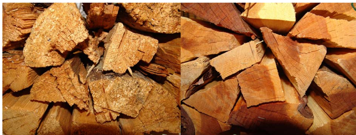
Figur 4. Värmevärdet vid en fukthalt i veden på 15 % beräknades till 1 653 kWh/m 3 f i gran med lösröta (vänster bild), vilket kan jämföras med ett värmevärde på 2 680 kWh/m 3 f i ved från kådrik tall (höger bild).
