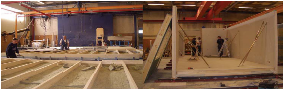
Figur 2: Exempel på hur tillverkningen av volymelement kan gå till i fabrik. 8
