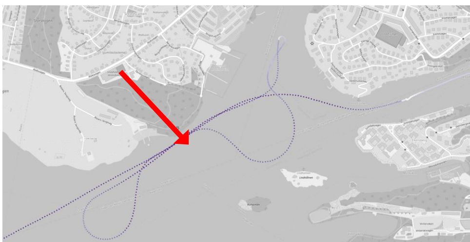
Figur 16 GNSS-data från fartyget Nova plottat på en karta från OpenStreetMap. © OpenStreetMaps bidragsgivare. Mätpositionen är markerad med en röd pil. Ju mörkare färg desto högre hastighet för fartyget Nova
