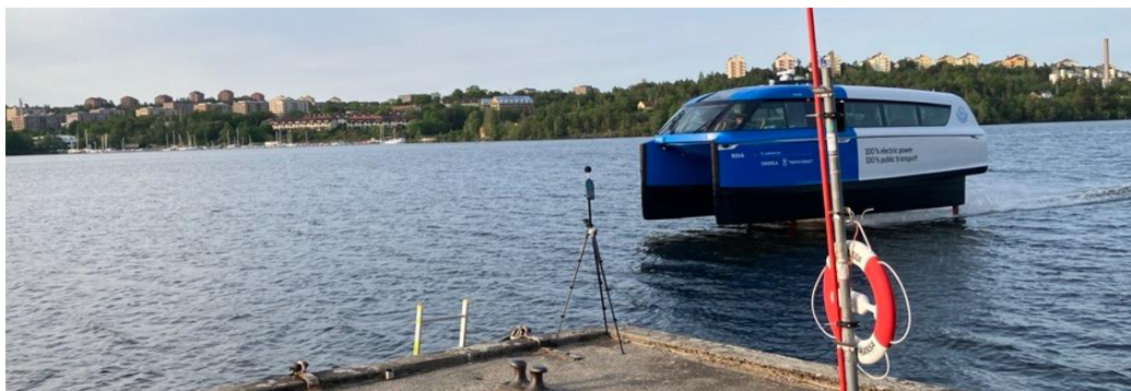
Figur 15 Ljudanalysatorn och det förbipasserande mätobjektet (Nova).
