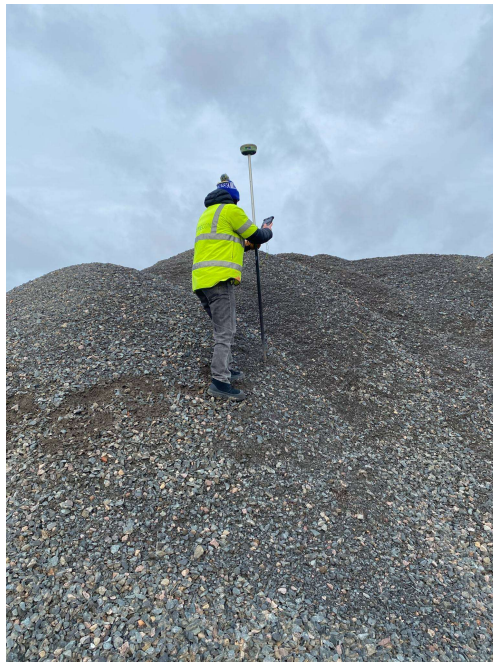
Figur 5. Handhållen inmätning med GNSS-utrustning
