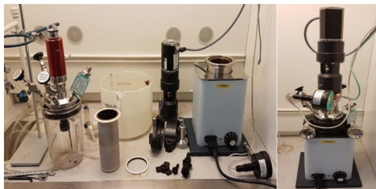
Figur 3. C-Greens labbreactor för HTC-behandling och våtoxidering. Bilden till vänster visar från vänster till höger: omrörare med reaktorlock, tefloninsats, motor och reaktor med värmemantel. Bilden till höger visar reaktorn i drift. Foto: Anders Uhlin (C-Green).
