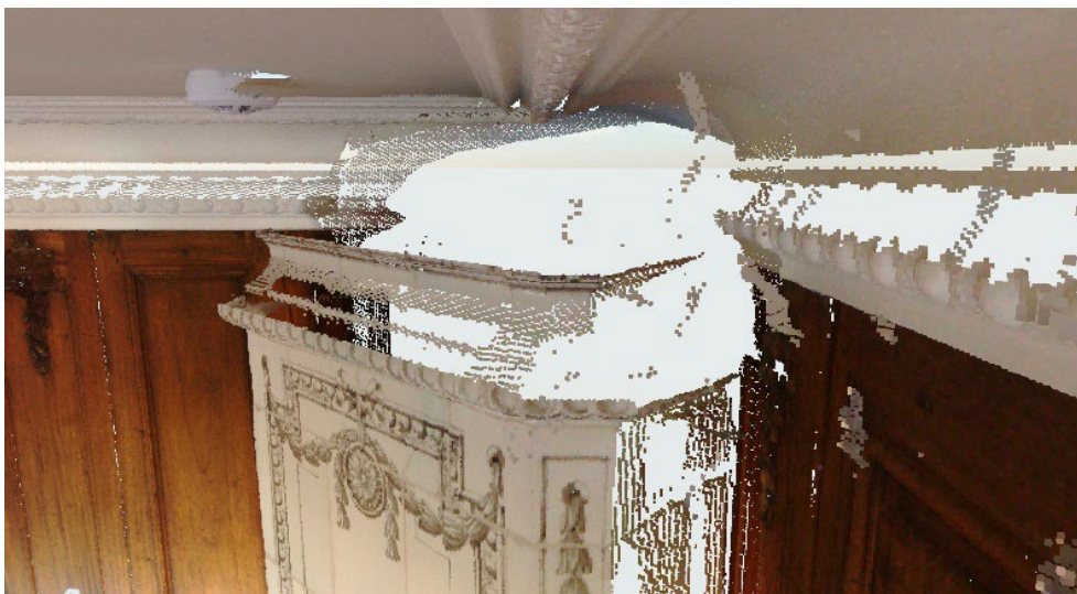
Skannad endast från ögonhöjd. Saknad data på ovansida kakelugn och listverk. Tottieska malmgården, Skansen. Bild: Thomas Hageus.
