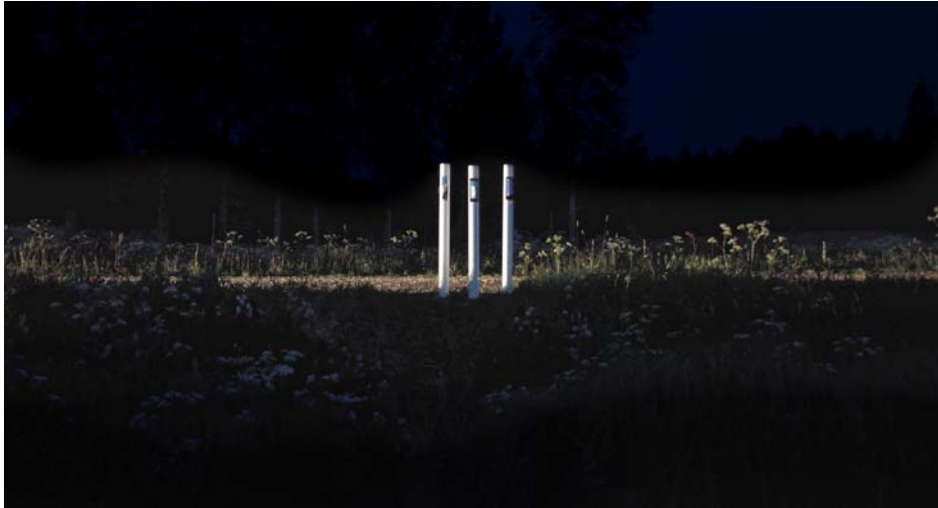
Bild 4. Exempel av resultat från Test A. Reflektorerna från vänster: Viltspiegel, Multivarnare, Halbkreisreflektor (blå folie). Bilden visar reflektorerna i en position som gav maximal effekt vid en position i rät vinkel mot väglinjen.
