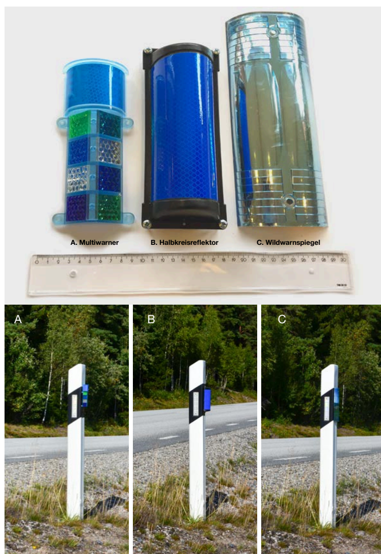
Bild 3. Tre reflektortyper som ingick i testet: A: multivarnare med "kattögon"; B: blå reflektorfolie på en halvcirkelyta; C: viltspiegel.
