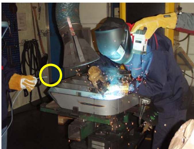
Bild 5. Provtagning av ozon via en slang fram till arbetsplatsen. Slangen (inringad) hölls normalt på två avstånd 0,5 och 1 m från svetsaren. På bilden ses även det partikelmätande instrumentet.
