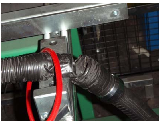
Bild 4, övre bilden till höger. Slangpaketet tätas med tape före mätningarna.
