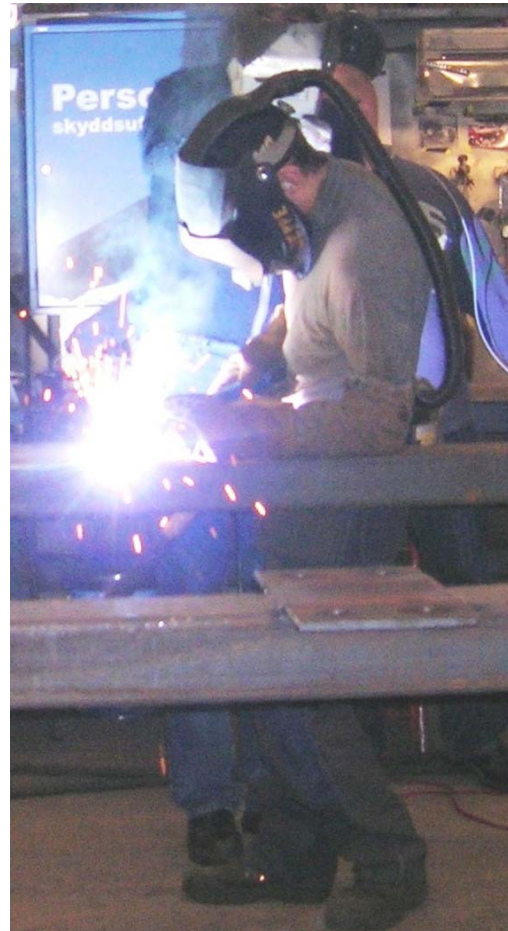
Bild 9. Står delvis lutad över plymen, men här rör sig plymen något mot svetsaren. Uppmätt halt i andningszonen: 51 mg/m 3 .
