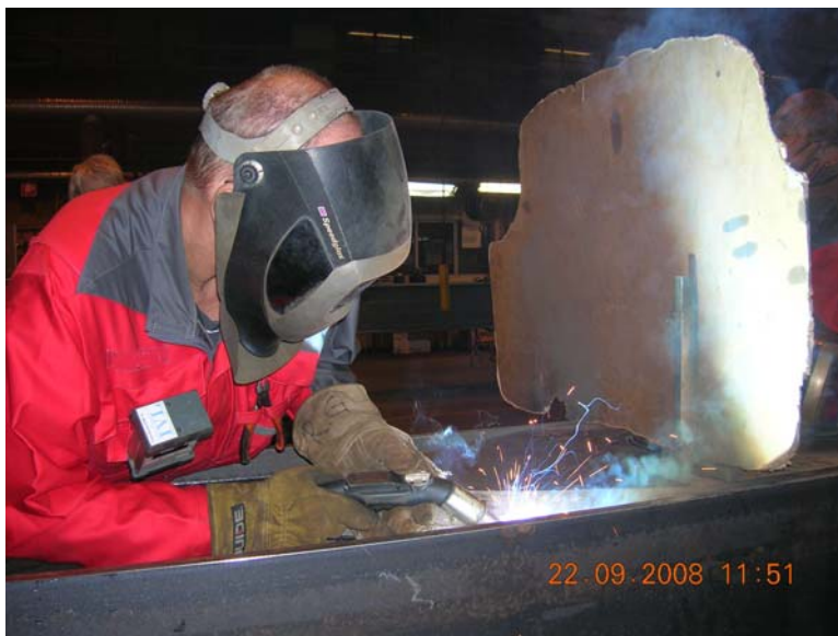
Bild 1. Mätning av svetsrök med direktvisande instrument för dammhalt.
