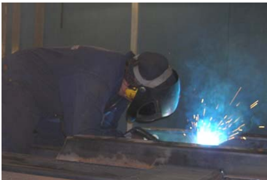
Bild 19. Svetsarens huvud är placerat snett över rökkällan och den mest koncentrerade röken passerar på avstånd från huvudet.
