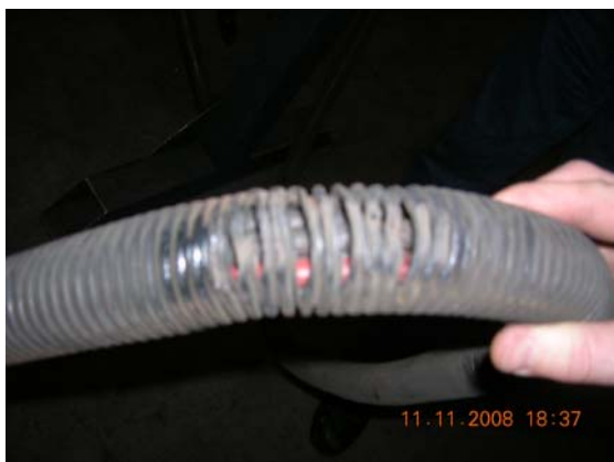
Bild 3, övre bilden till vänster. Hål på slangar orsakade av slitage och värme var vanliga.
