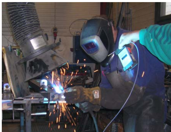
Bild 11. Ovan till höger. Utsuget på armen bra placerat i samband med svetsning. På bilden ses även instrumentet som användes för mätning av svetsrök och slangen till mätinstrumentet för ozon.
