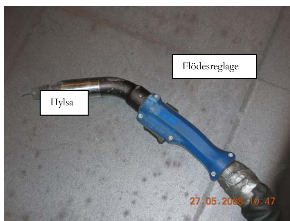
Bild 1. Svetspistol med integrerat utsug från Binzel.
