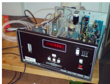
Bild 6. Instrument för mätning av ozon från Monitor Labs Inc, model 8810. På bilden har chassit tillfälligt öppnats för en mindre justering.
