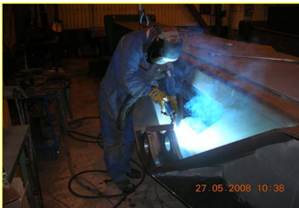
Bild 8. Står delvis lutad över, men drag för bort delar av plymen. Uppmätt halt i andningszonen: 1,7 mg/m 3 .
