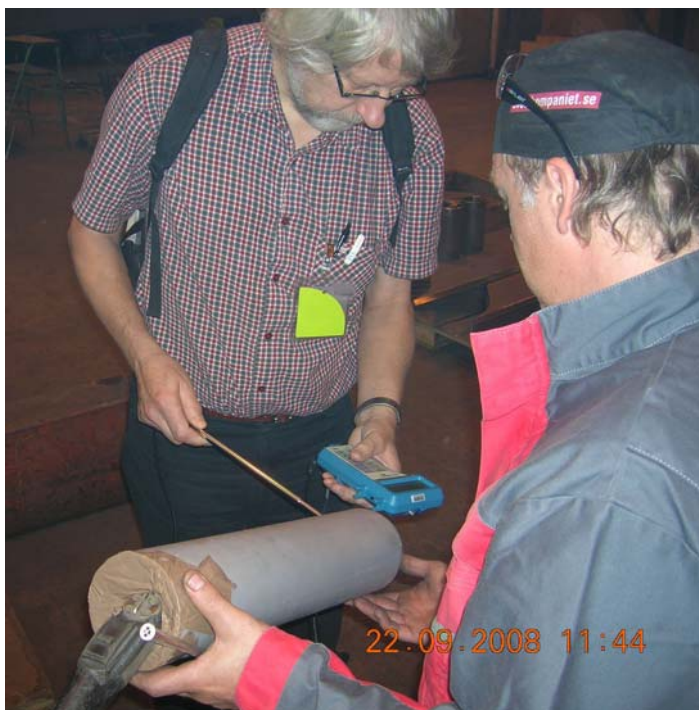
Bild 3. Lufthastighetsmätning av det integrerade utsugets flöde.
