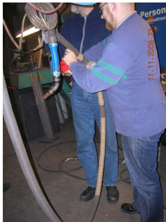
Bild 4, övre bilden till höger. Slangpaketet tätas med tape före mätningarna.
