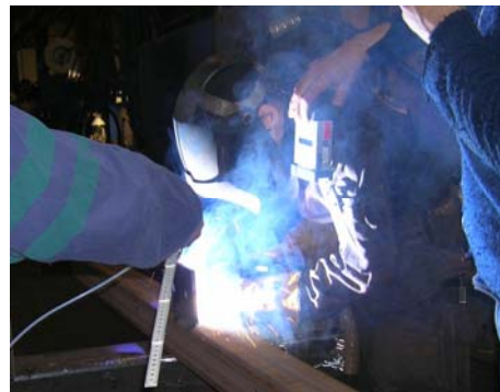
Bild 20. Svetsaren lutar sig över arbetsstycket och röken stiger rakt mot ansiktet.
