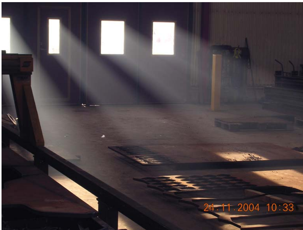
Bild 12. Dimman på bilden härrör från svetsrök. Om allmänventilationen är dålig, ventileras röken inte ut utan sprids i hela lokalen. Bilden är från ett smidesföretag som besöktes i ett tidigare projekt. Efter besöket vidtogs ventilationstekniska åtgärder.
