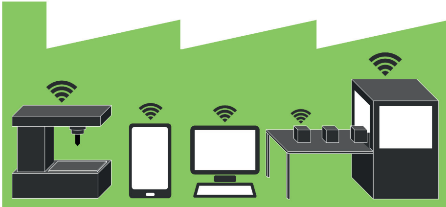
Figur 3. Vertikal integration syftar till integrering mellan olika typer av enheter och system inom den smarta fabriken.
