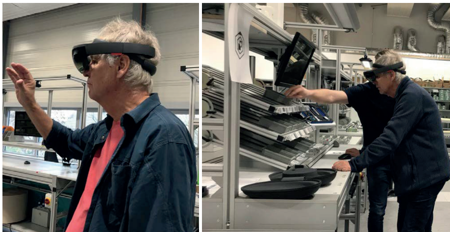
Figur 7. Den förstärkta operatören understöds med AR vid en monteringslina. Virtuella instruktioner integreras i operatörens synfält. Operatören får information om vilka detaljer som ska plockas samt hur dessa ska monteras ihop.
