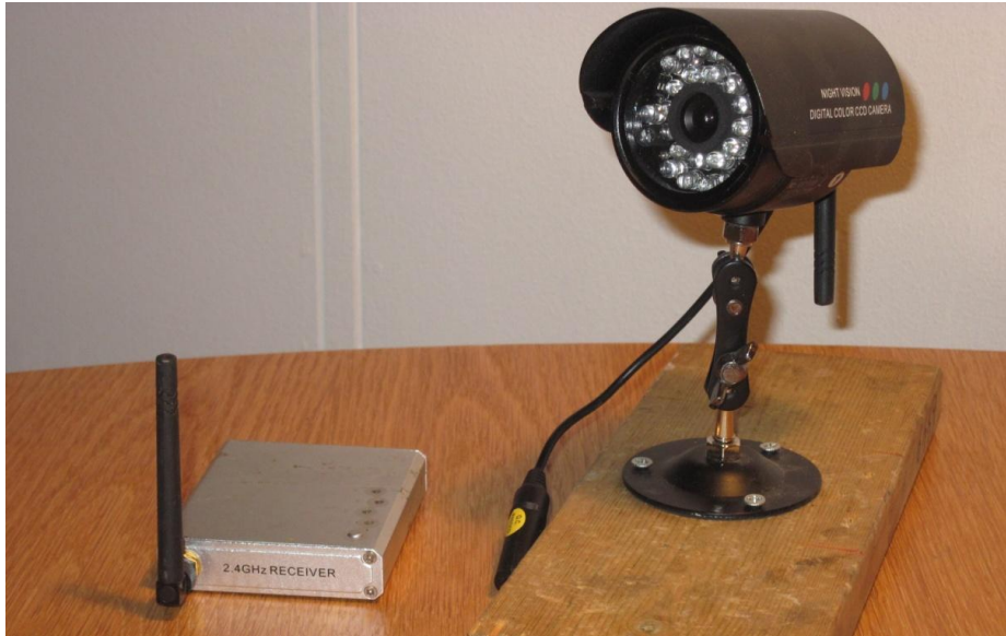
Figur 1. Bild på 2,4 GHz-mottagaren till vänster samt kameran till höger.
