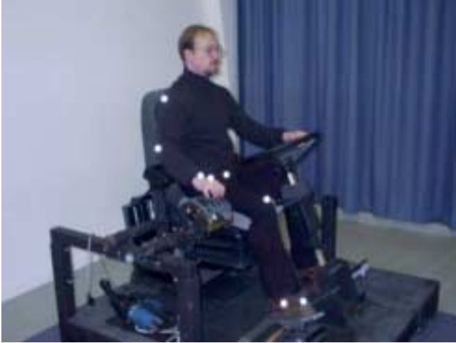
Figur 9. Bild över reflexmarkörernas placering på försökspersonen. Reflexmarkörerna på reglageställ och armstöd är inte monterade i bilden.
