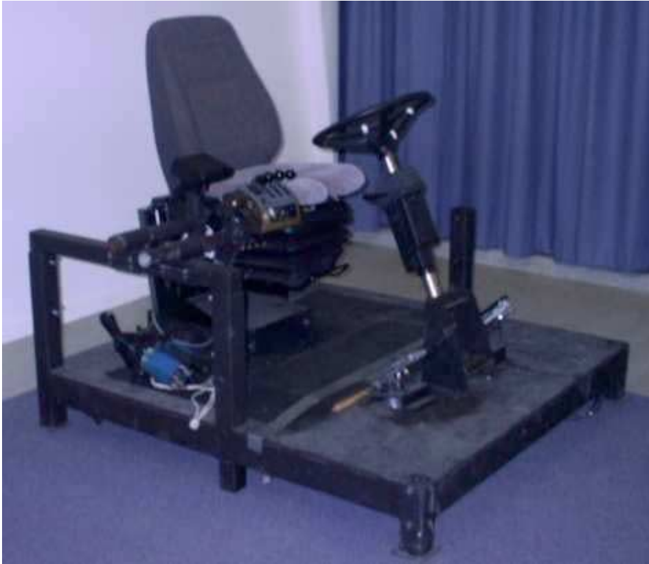
Figur 6. Den i försöken använda hyttmock-upen med linjärspakar, stol, ratt och pedaler.
