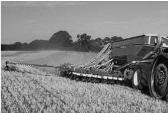
Figur 4. Spårmarkören gör ett spår i den obehandlade delen av fältet så att föraren vet var han ska köra nästa drag. Foto: Väderstad Verken AB
