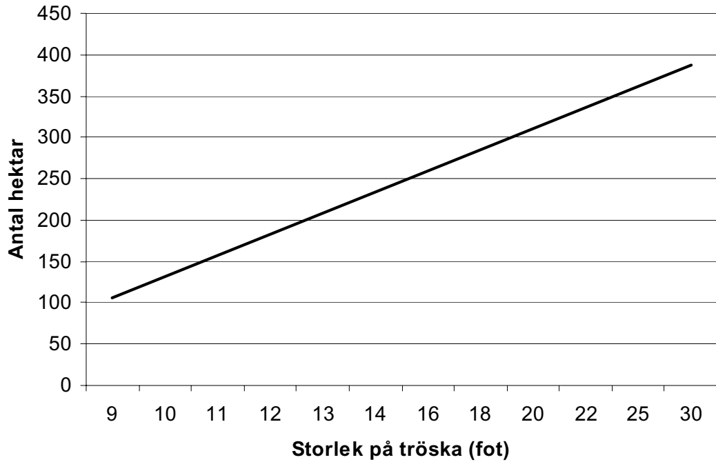
Figur 11. Det arealunderlag som krävs för att ekonomiskt motivera investering i GPS-autostyrteknik till en skördetröska. Investeringen ska finansieras med inbesparade rörliga kostnader.
