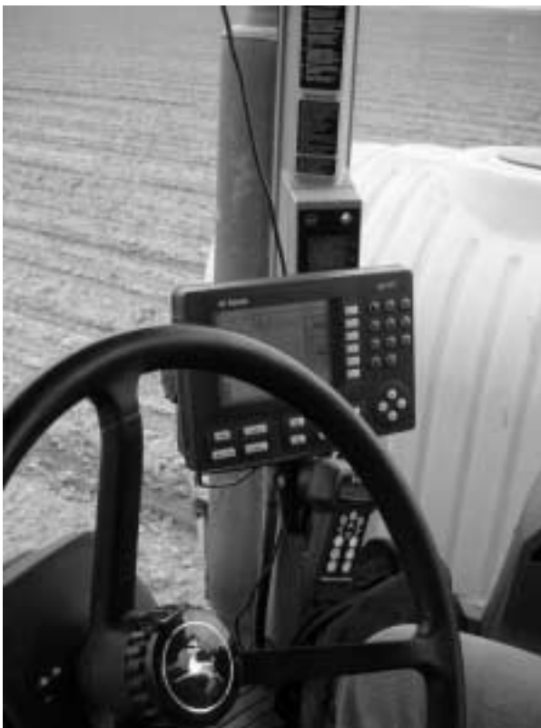
Figur 2. Kontrollbox och loggdator till en Trimble Autostyrutrustning. Foto: Christoffer Anderson
