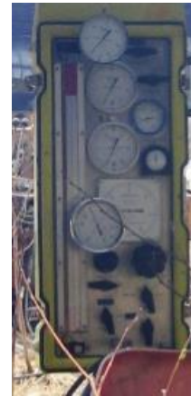
Figur 4. Pressometeravläsare (bild: Hanke & Matini, 2015)
