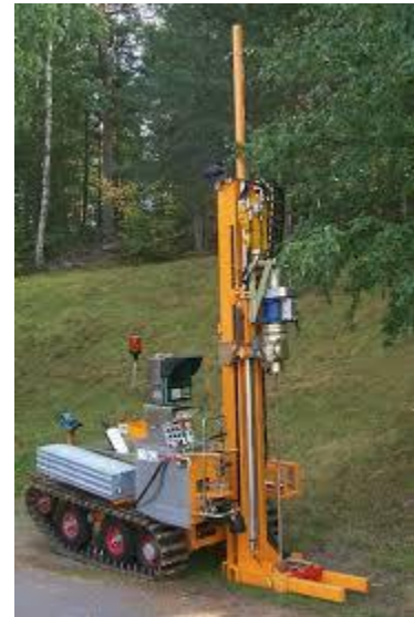
Figur 21: Borrhvagn med hejarsondering (bild: knutpunktget, 2011)
