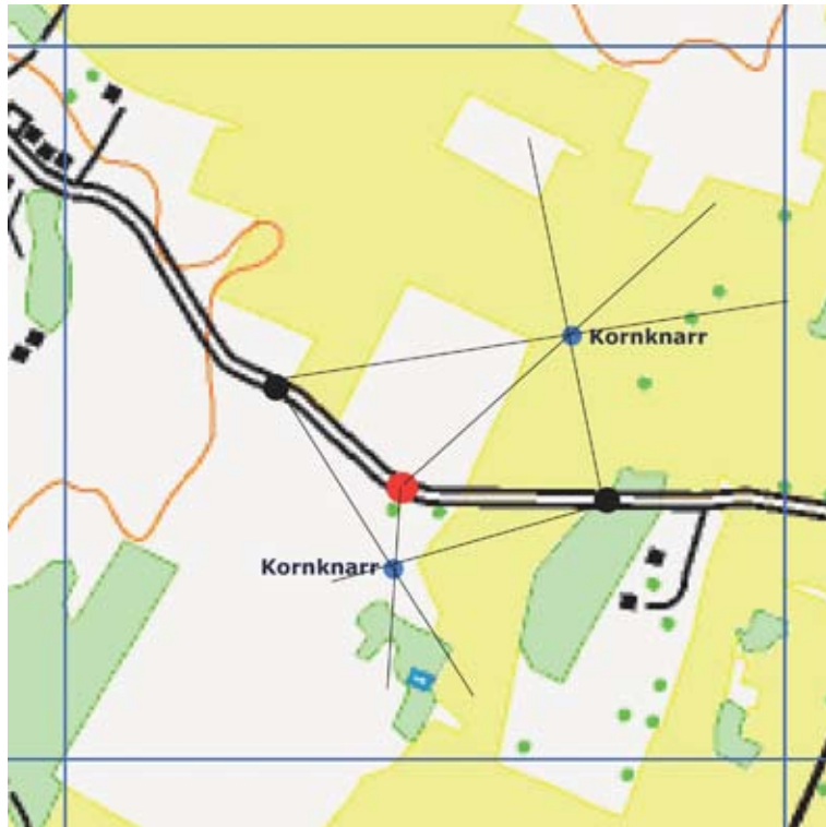
Figur 3. Princip för hur kornknarrar lokaliserar via triangulering. Bärningen till fågeln tas från observationspunkten (röd punkt). Därefter tas bärningen från ytterligare minst en punkt (svarta punkter)
