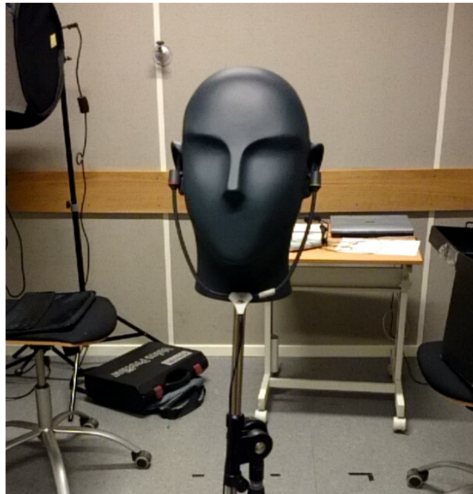
Figur 3. Dockhuvudet och mikrofonerna som användes till inspelningen. Dockhuvudet satt fastskruvat på ett stativ.
