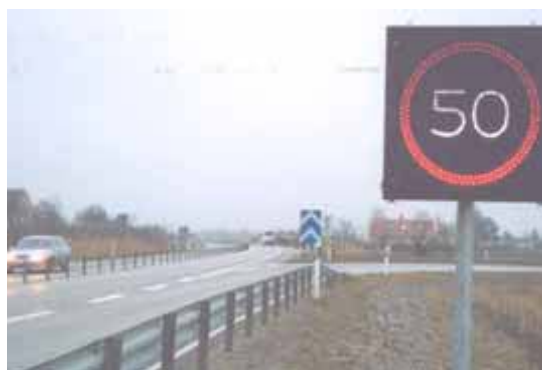
Figur 8 Exempel på omställbar elektronisk skylt aktiverad genom t.ex. trafikförhållanden.
