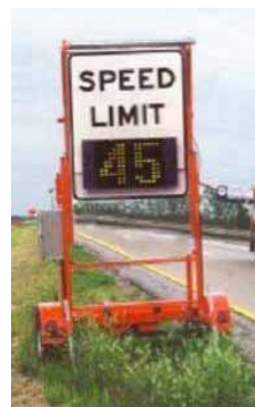
Figur 10 Exempel på mobila fordonsaktiverade hastighetsbegränsningsskyltar använda vid vägarbeten (USA).
