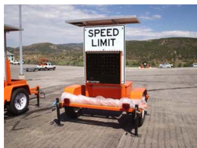
Figur 10 Exempel på mobila fordonsaktiverade hastighetsbegränsningsskyltar använda vid vägarbeten (USA).
