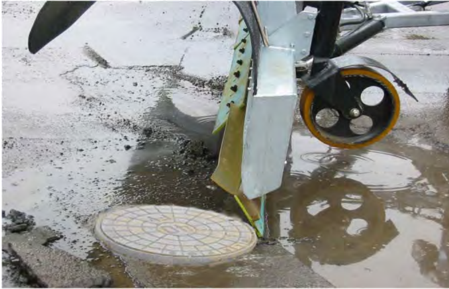
Figur 9 Påkörning av brunnslöck med Miljöplogets förplog. Foto: Hans Sarsten, HDS Entreprenad. Fotomontage: Göran Gabrielsson, GABBÉAB.
