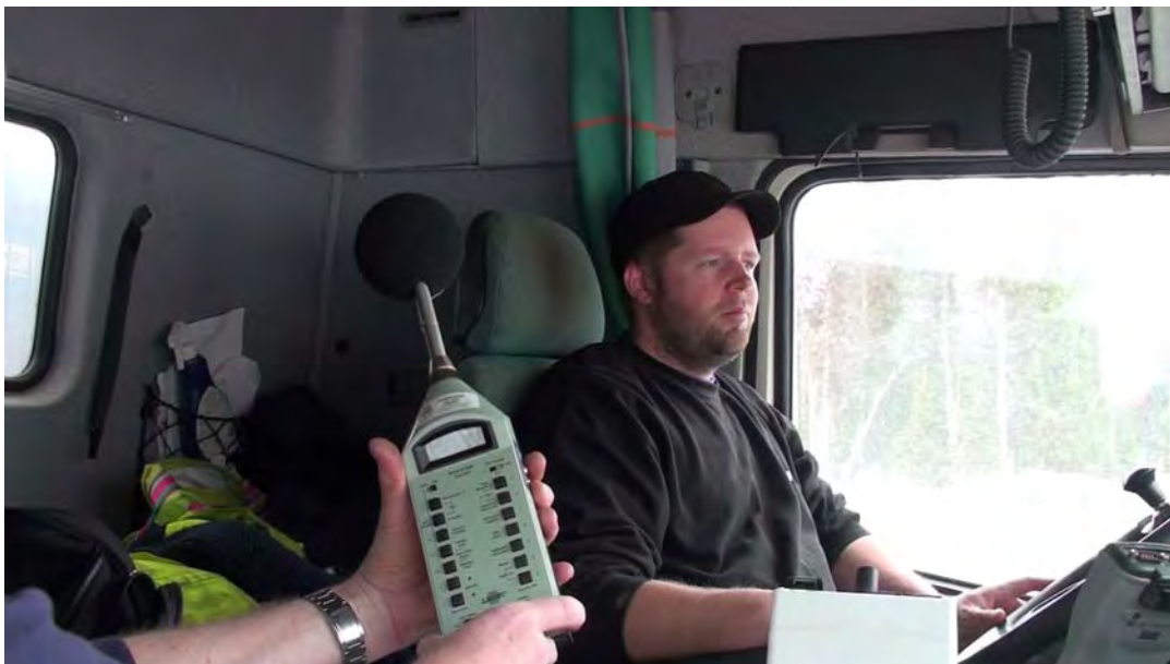
Figur 8 Mätning av buller i lastbilshytten. Foto: Göran Gabrielsson, GABBÉAB.
