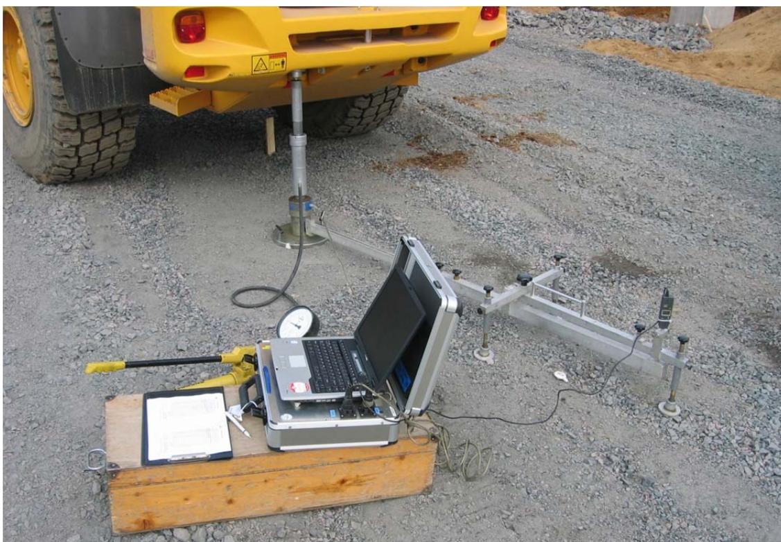
Figur 1 Mätning med utrustning för statisk plattbelastning. Foto: Håkan Arvidsson, VTI.
