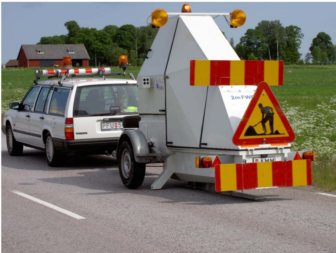
Figur 3 Bilden visa en tung fallvikt som utför mätning. Foto: Håkan Carlsson, VTI.
