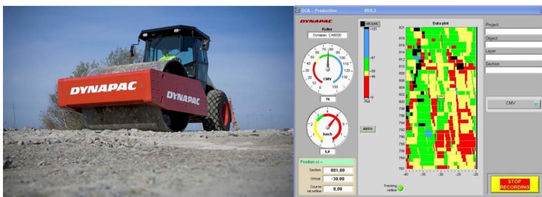
Figur 2 Bilden visar packningsmätarinformation (Dynapacsystem) från en modern vält kopplat till GPS-data. GPS har använts för positionering, relaterat till vägens referenslinje (oftast centrumlinje). Röda områden är sämst packade, därefter blir det gult, grönt, blått och blir det riktigt styvt blir det dubbelhopp och markerat med svart. Foto: Ingmar Nordfelt, Dynapac.
