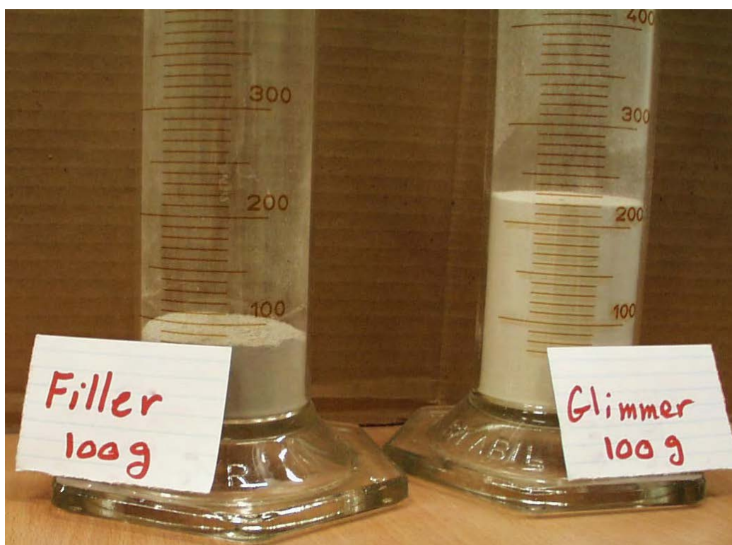
Figur 2. Bilden visar skillnad i volym mellan filler (granitiskt ursprung) och glimmer.
