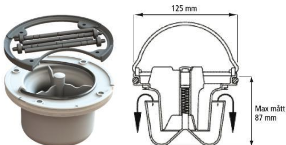
Figur 8.2. Vattenlås med låsring. [24]
