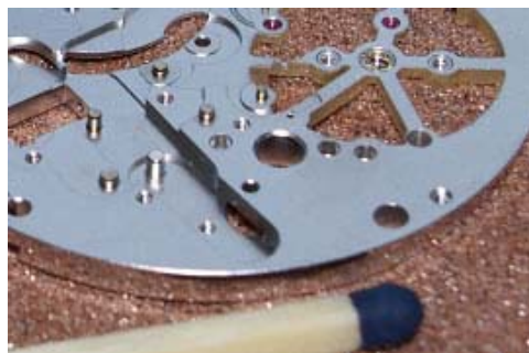
Figur 10. Bilden illustrerar skärprecisionen i vattenskarning hos maskinen AWMM, storleken på urverket jämförs här med en tändsticka.
