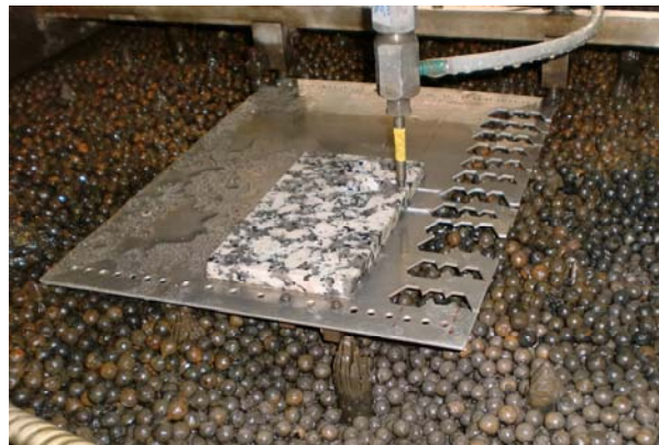
Figur2. Tank uttömd på vatten, med kulor för energiskingring under stenskivan som ska skäras.
