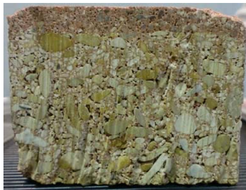
Figur 3. Bilden visar ett fotografi av tvärsnittet efter skärning av en gatsten med tjockleken 150 mm. Den nedre delen är räfflad på grund av en eftersläpande stråle, vilket resulterat i en vågformad yta. Skärriktningen är åt höger.
