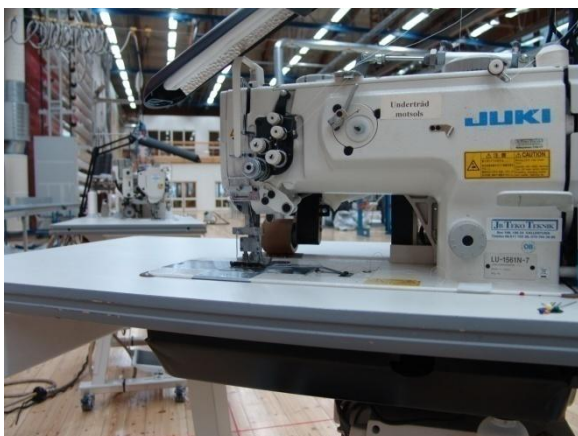
Figur 5 Symaskin som används för att foga dukar och sy kanter.
