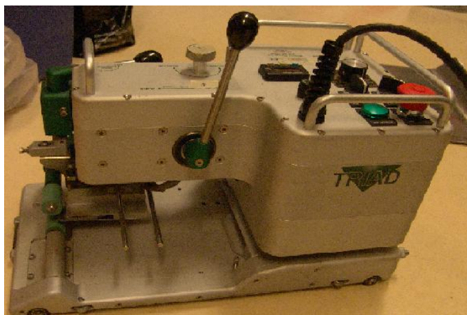
Figur 8 Svets med värmekil
