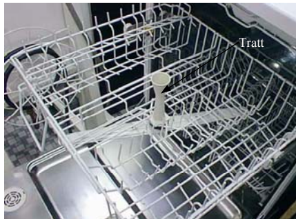
Bild 9 Tratt som samlar upp vattnet
