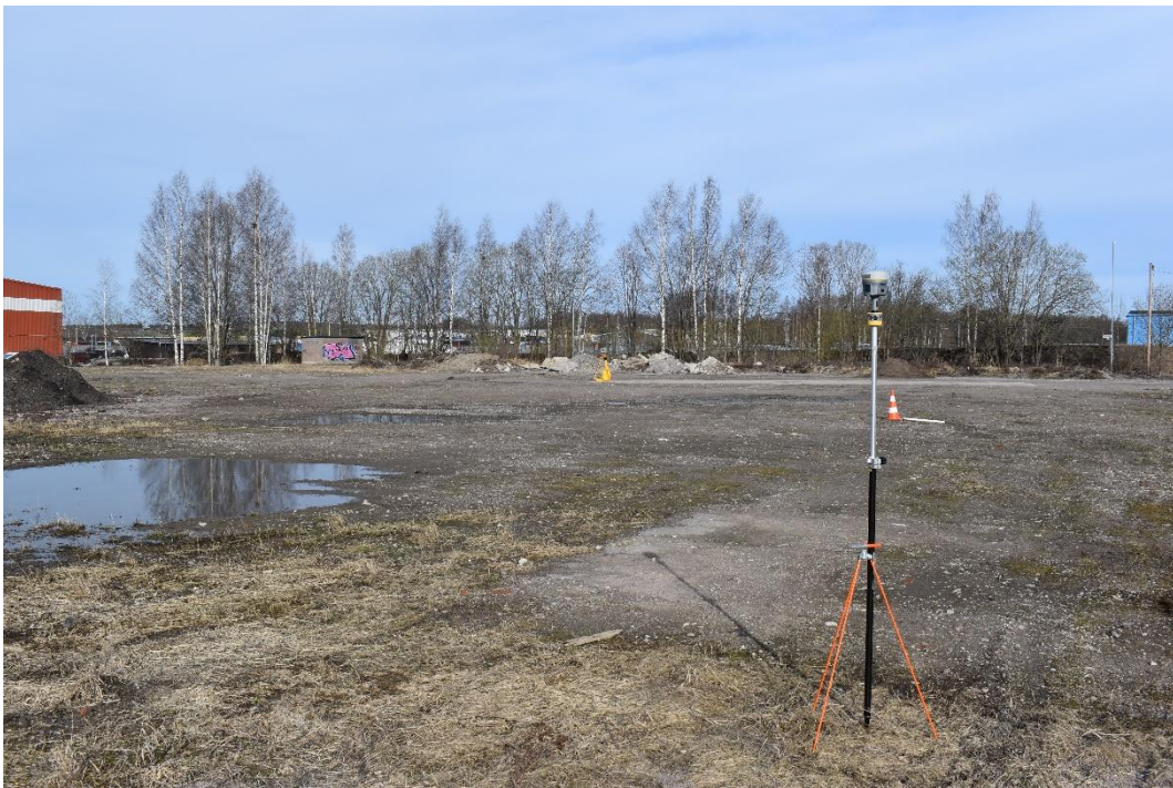
Figur 12. Stationsetablering med RUFRIIS-metoden med ett bakåtoobjekt.
