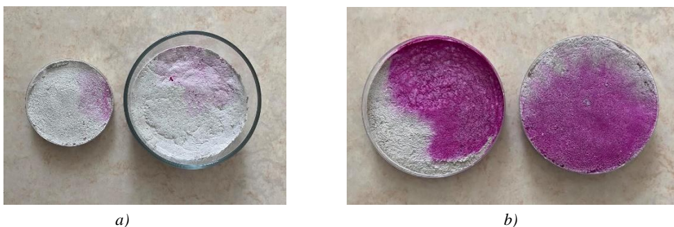
Figur 11. a) Tjocklek 22 och 5 mm i rumstemperatur ca 20°C b) Tjocklek 15 och 7 mm i frys, temp ca –15°C.
