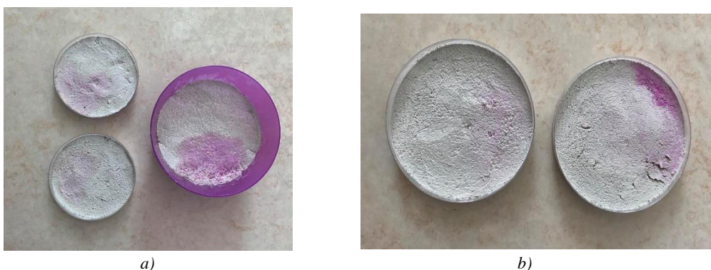
Figur 12. a) Tjocklek 5,10, 20 mm, balkong, temp 7–22°C b) Tjocklek 5 och 10 mm, kylskåp, temp ca 5°C.
