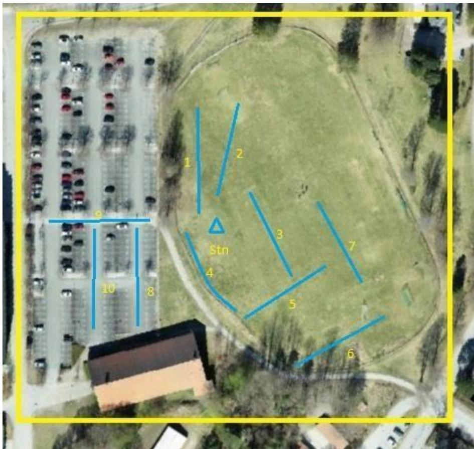
Figur 9. Illustrering av samtliga kontrollprofiler (1-10) samt placering av totalstation.
