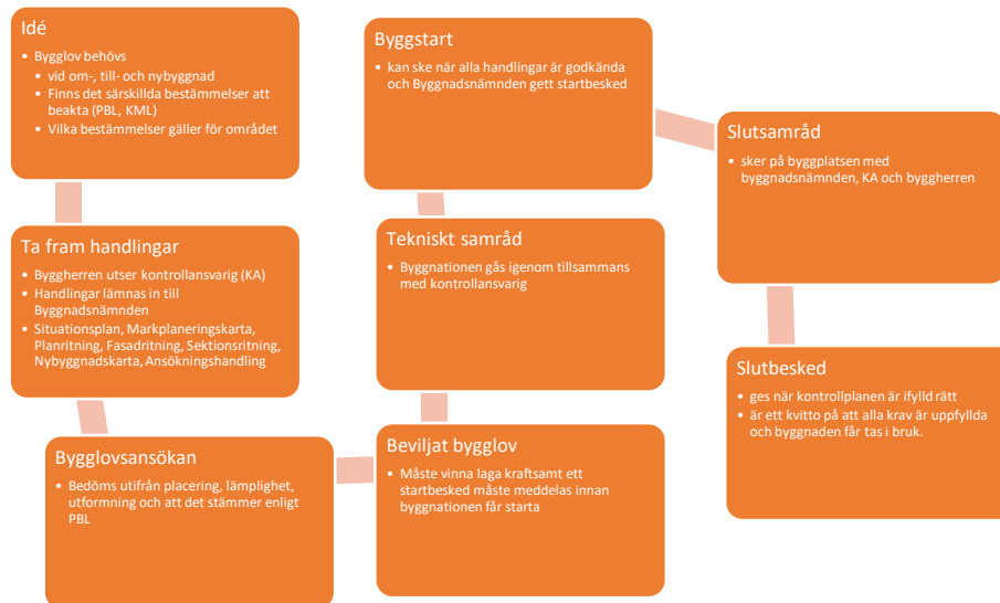
Figur 2: Bygglövsprocessen sett ur byggherrens perspektiv.
