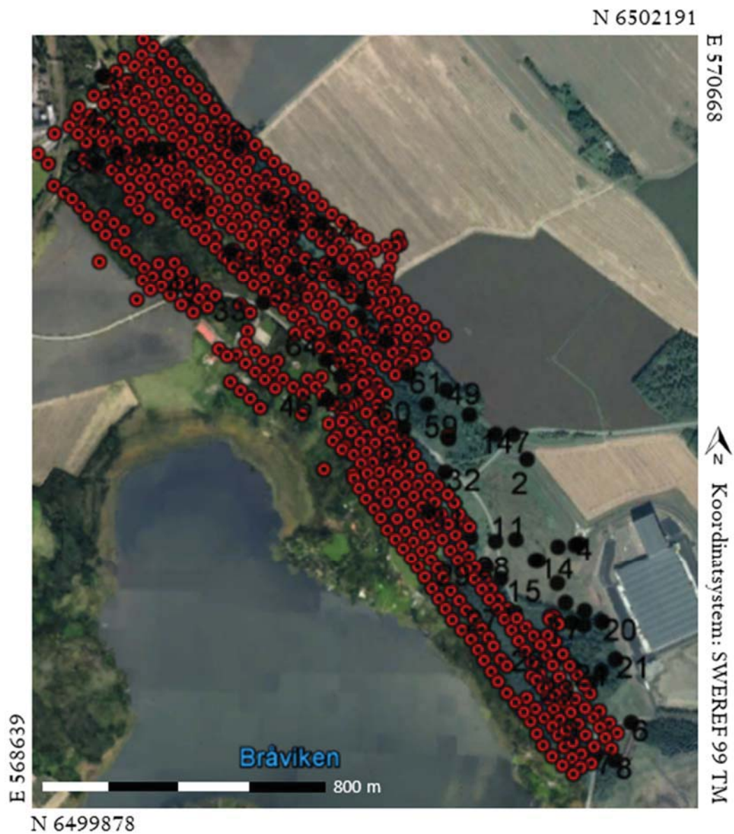
Figur 4. Ovan illustreras kamerastationerna och flygsignalerna från hela flygningen över studieområdet med Smartplanes SIC. De röda markeringarna symboliserar kamerastationerna för varje bild som togs. I den sydöstra delen saknas kamerastationerna och endast flygsignalerna (markerade som svarta cirklar) syns. Bild hämtad från GOOGLE-EARTH 2018 06 09.
