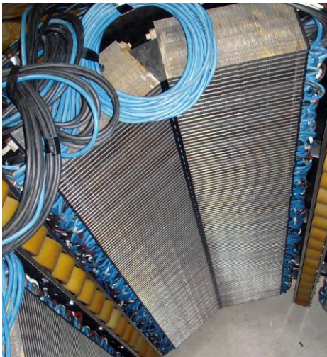
Figur 3. Bild på en monterad stator från insidan av generator, ur rapporten Robotized Stacking of the Uppsala University Wave Energy Converter Generator Stator
