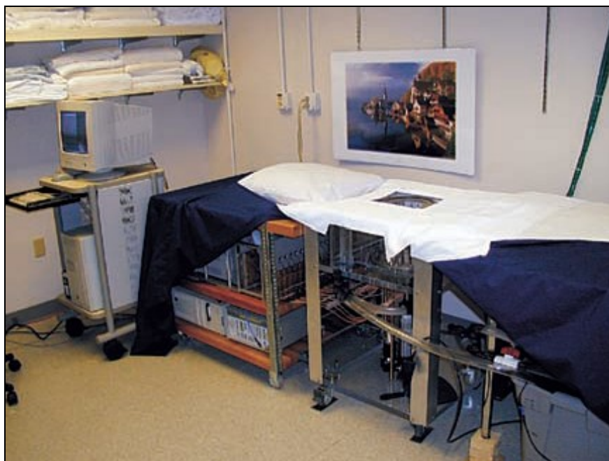
Figur 3.1: Här syns prototyp för mikrovågstomograf, en brits där patienten får ligga på mage vid undersökning, med det bröst som undersöks i nedsänkt i ett kopplingsmedium i britsens mitt. Där omges det av cirkulärt ordnade antenner för sändning och mottagning av signal. På denna prototyp har utrymmet under britsen utnyttjats för hårdvaruförvaring. Källa: Bild och text hämtad från IEEE Microwave Magazine, No 2, Mar, 2002, s. 51 [23].
